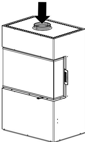
Abb. 33: Rauchgaswege von oben reinigen
