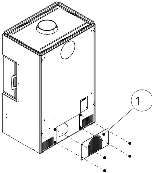
Abb. 13: Rückwandrevision demontieren
