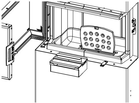
Abb. 38: Aschebox rausnehmen und entleeren
