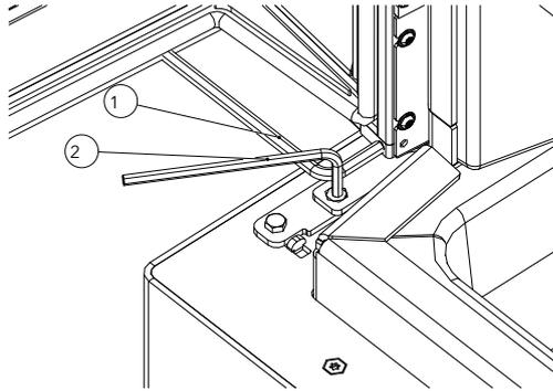
Abb. 26: Feder sichern und Schraube lösen
