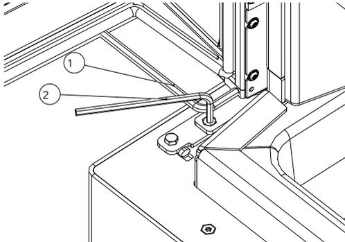
Abb. 39: Feder sichern und Schraube lösen
