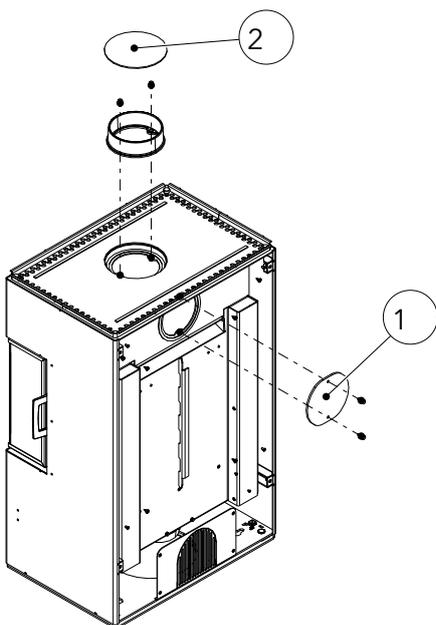
Abb. 10: Abdeckung und Stützen demontieren
