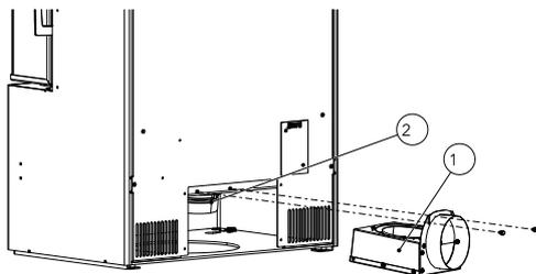
Abb. 14: Zuluftadapter montieren
