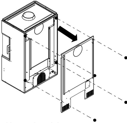
Abb. 8: Rückwand abmontieren
