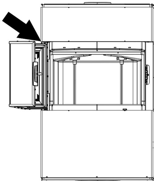
Abb. 41: Tür aushängen und demontieren
