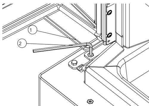
Abb. 29: Feder lösen und sichern
