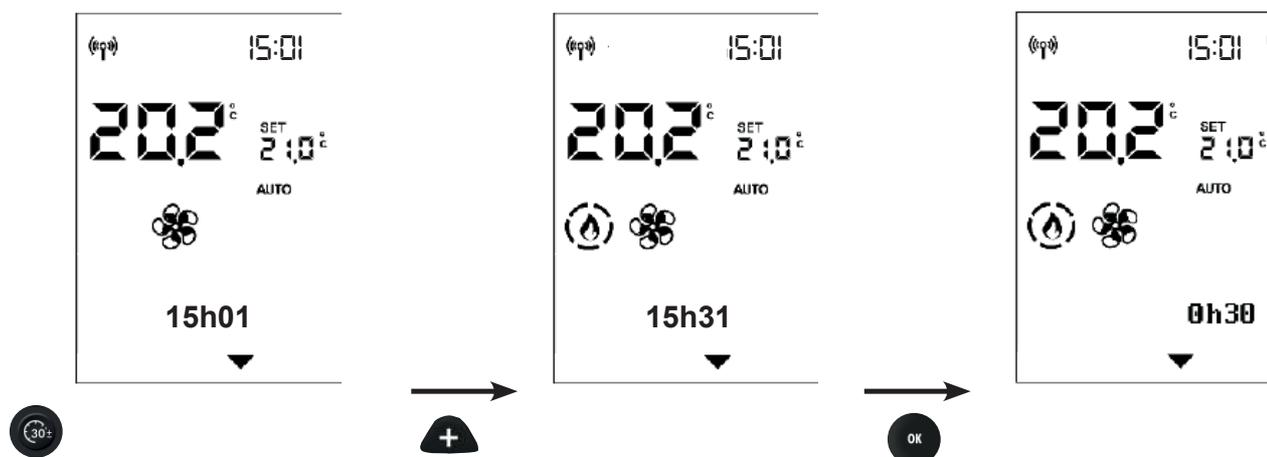
Auf der Leiste wird weiterhin der Countdown angezeigt, der nach unten zählt, bis das Gerät aus- oder eingeschaltet wird.
