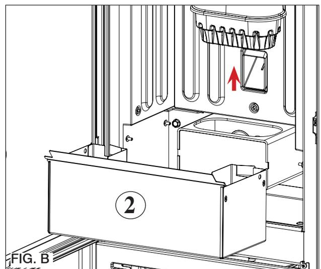
**⚠ ACHTUNG: SICHERSTELLEN, DASS DER ASCHENKASTEN ORDNUNGSGEMÄSS EINGESETZT IST.**
