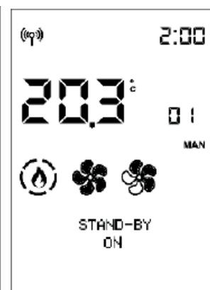
Durch Drücken der Taste
