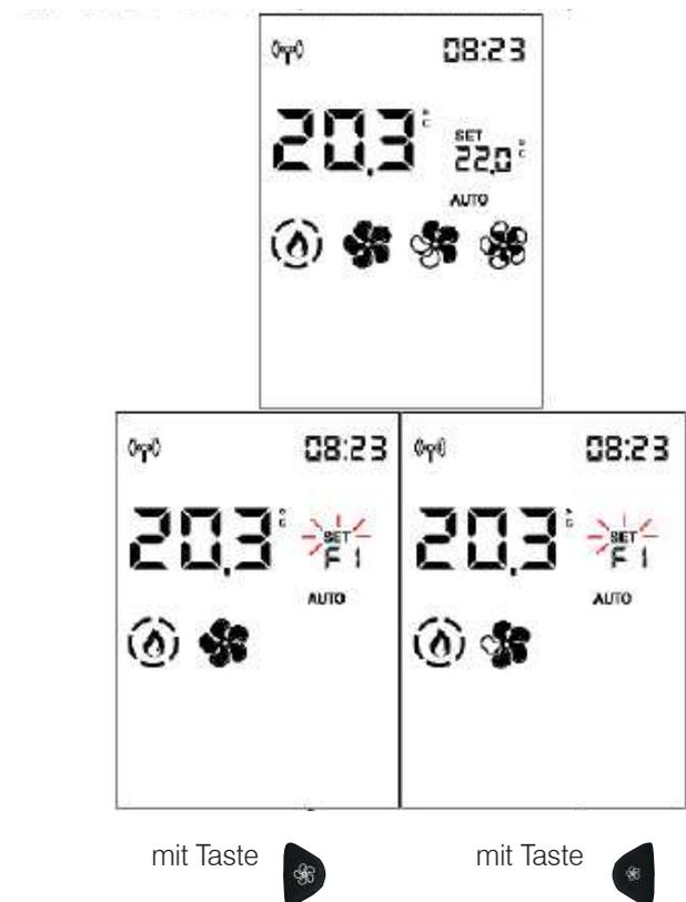
Die Einstellung wird mit der Taste
