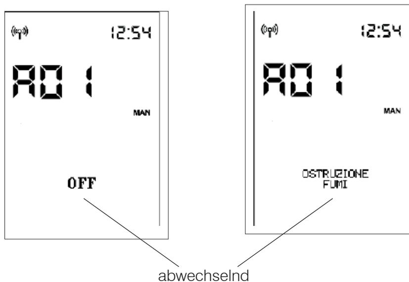
Bei Alarm wird anstelle der Raumtemperatur der Alarmcode angezeigt.
