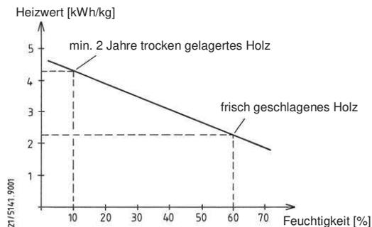
Nur mit trockenen Brennstoffen erreichen Sie eine optimale Verbrennung und heizen umweltschonend. Durch die Brennstoffaufgabe in Teilmengen wird eine unnötige Emission vermieden. Einen sauberen Abbrand erkennen Sie daran, dass sich die Schamotte hell verfärbt.
