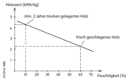
Nur mit trockenen Brennstoffen erreichen Sie eine optimale Verbrennung und heizen umweltschonend. Durch die Brennstoffaufgabe in Teilmengen wird eine unnötige Emission vermieden. Einen sauberen Abbrand erkennen Sie daran, dass sich die Schamotte hell verfärbt.
