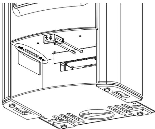
Abb. 39: Einstellschrauben Seitenverkleidung
