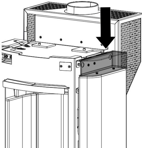
Abb. 29: Griffbox einsetzen
