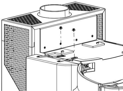
Abb. 53: Halter lösen
