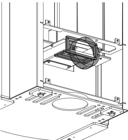
Abb. 22: Luftanschluss hinten
