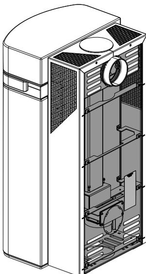
Abb. 16: Rückwand montieren
