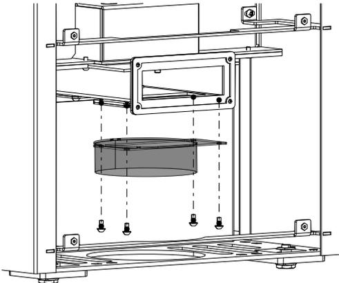
Abb. 20: Zuluftflansch unten demontieren
