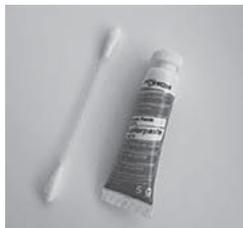
Zum Auftragen der Schmierpaste gehen Sie wie folgt vor: Die Feuerraumtür öffnen und fixieren. Etwas Schmierpaste auf das Wattestäbchen auftragen und die Federaufnahme des Türverschlusses damit benetzen. Die am Korpus befestigte Aufnahmerolle während des Auftrags von Hand drehen. Die Feuerraumtür einige Male schließen und öffnen und ggf. die Kupferpaste nochmal nachtragen.
