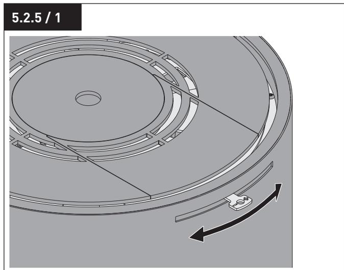
Die Abgabe der Wärme aus den Speichersteinen kann über den Konvektionsluftschieber geregelt werden.
