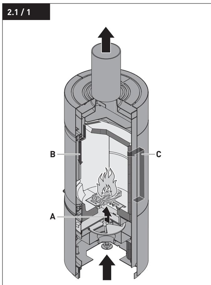
Die Verbrennungsluft wird in drei Luftstromarten unterschieden:
