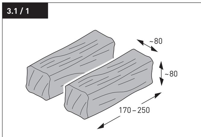
1,4 kg Holz entsprechen zwei durchschnittlichen Holzstücken (Länge 170 – 250 mm, Breite/Höhe ca. 80 mm).
