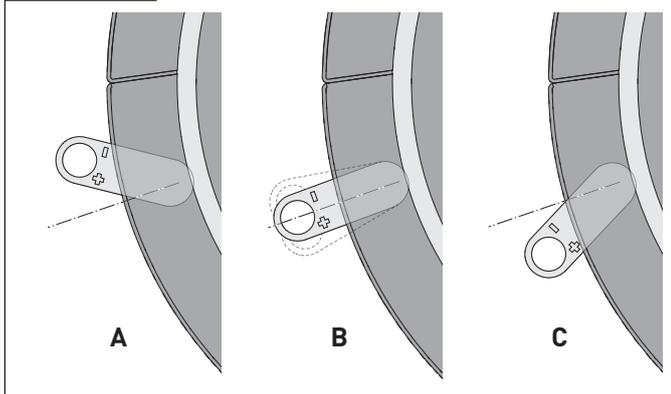
Die Regelung der Verbrennungsluft erfolgt stufenlos durch Betätigen des Verbrennungsluftschiebers bei geschlossener Feuerraumtür.
