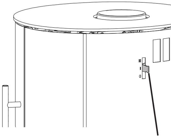
Bedienhebel für die Konvektionsluft
