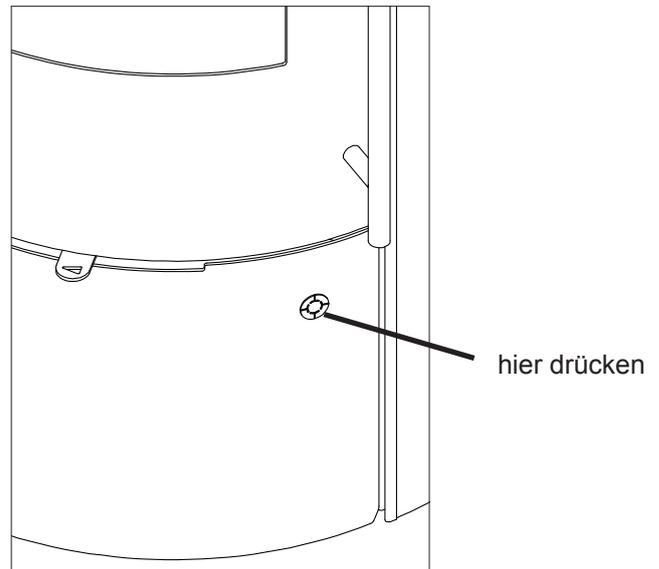
Das Holzlagerfach unterhalb des Brennraums ist mit einem Magnet-Druckverschluß ausgerüstet. Es lässt sich durch leichtes drücken auf den Taster (Olsberg-Logo) öffnen. Das Verschließen erfolgt ebenso durch leichtes drücken.
