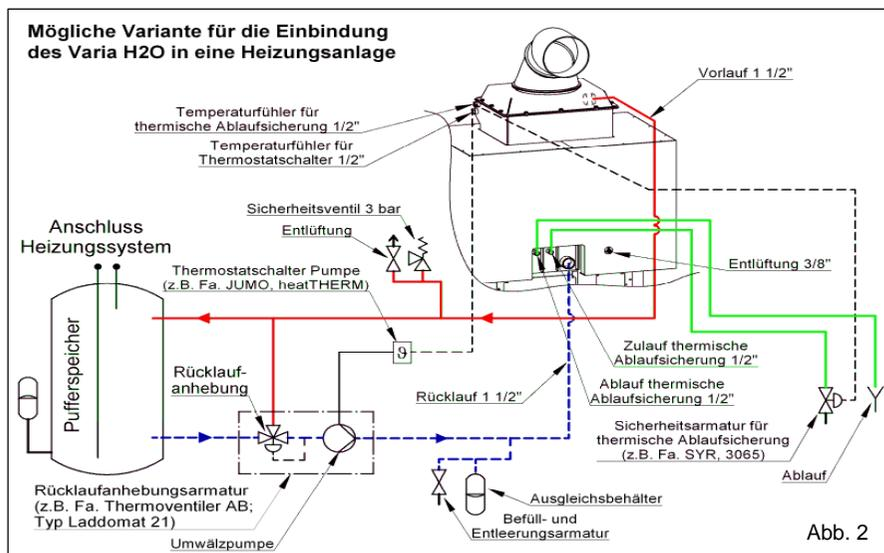
**Bitte beachten Sie:** Die **Abbildung 2** zeigt eine Möglichkeit wie der Varia 1V H<sub>2</sub>O XL in eine bestehende Heizungsanlage integriert werden kann. Diese ersetzt allerdings nicht die ausführliche Planung der Installation durch ein Fachunternehmen.
