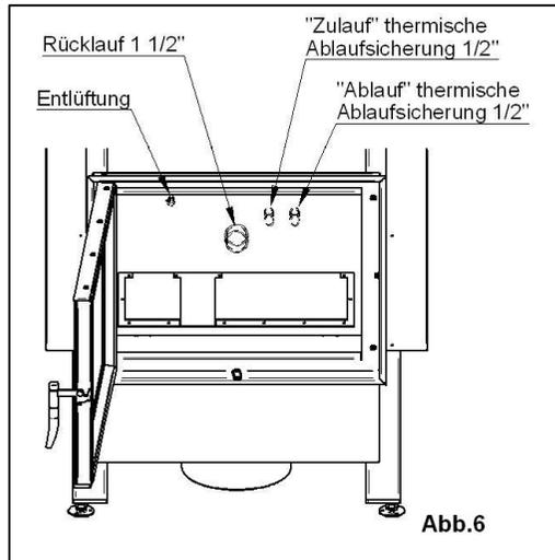
Für den Zugang zu den wasserseitigen Anschlüssen des Varia 1V H<sub>2</sub>O XL, kann eine Revisionsöffnung in der Rückwand geöffnet werden (siehe Abb. 6). Dazu ist die Brennumkleidung (Seitenwände, Rückwand, Ascherost, Aschetopf und Brennraumboden) zu demontieren.
