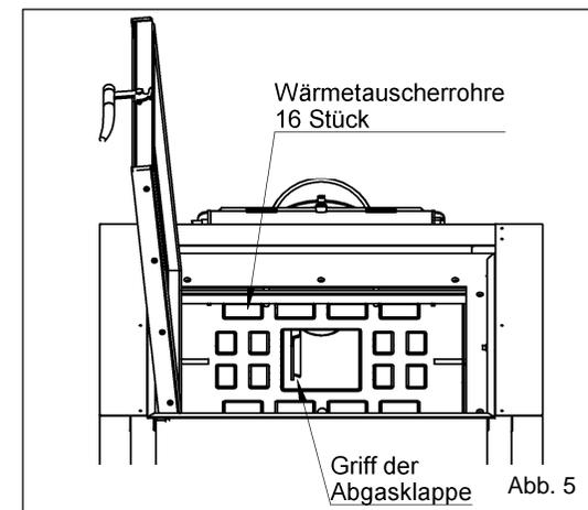
Nach der Reinigung erfolgt die Montage in umgekehrter Reihenfolge. Erst die thermische Abgasklappe einhängen (schräg von unten einführen und auf die Auflagen legen). Danach die Flammenprallplatte so einlegen, dass der Abgasspalt auf der Scheibenseite liegt.
