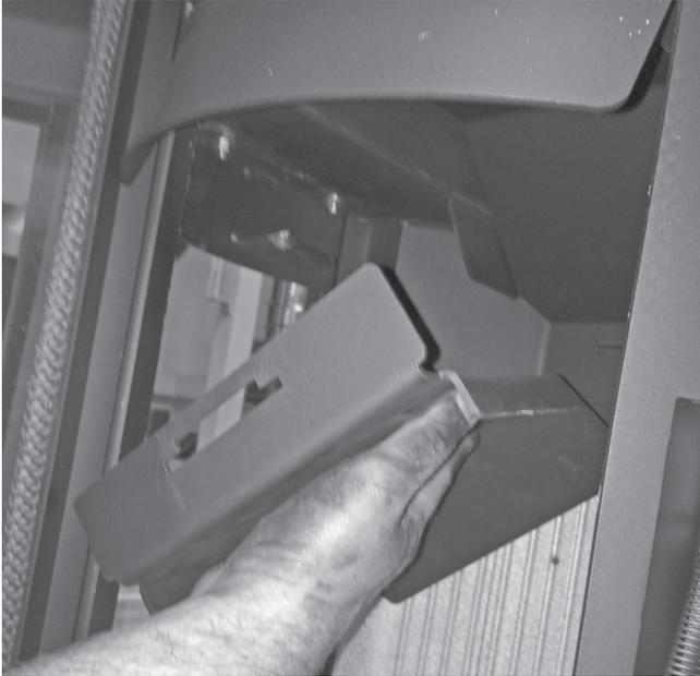
Die 2. Stahlumlenkung ist hinten eingehängt:
