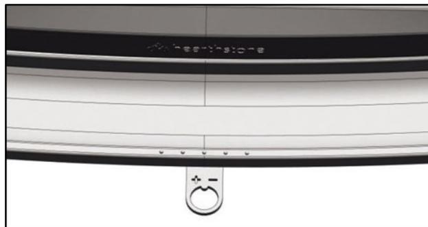
**MITTEL-HOHE VERBRENNUNG:** Wenn sich der Hauptluftregler in der mittleren Position befindet, bewegen Sie den Luftreglerhebel etwa 10 mm nach links (siehe Abbildung unten).
