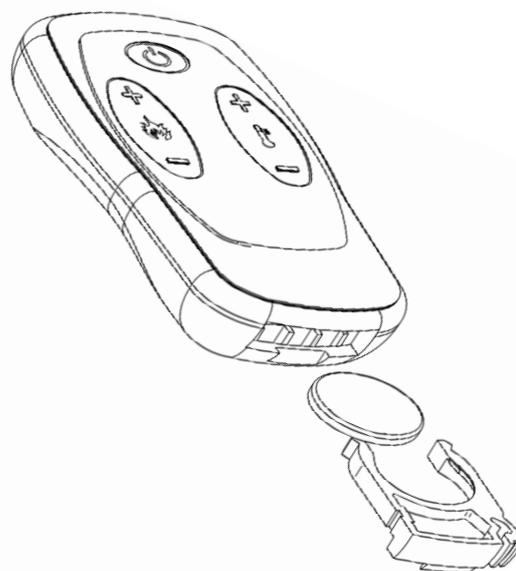
Für den Betrieb ist 1 Lithium-Pufferbatterie CR2025 von 3V erforderlich.
