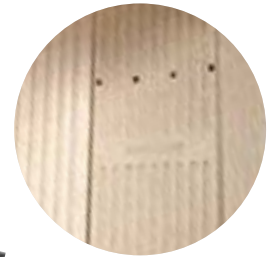
Profilierte Vermiculite-Auskleidung mit Max.-Load-Beschriftung
