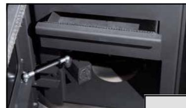
Hydraulischer Türverschluss, Ascheschublade
