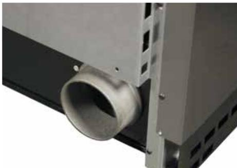
Die Verbrennungsluft (Primär-, Sekundär- und Tertiär) ist durch einen einzigen ø 100 mm Verbindungsstutzen kanalisiert und direkt von Außer verbindbar
