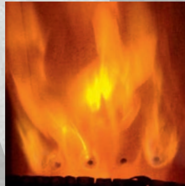
Tertiärluft wird durch Düsen im hinteren Brennraumbereich „eingebblasen“
